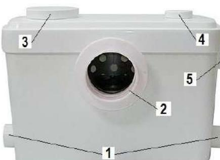
**Конструкция:** блок автоматики (поплавок + микропереключатель) и фекальный насос (электродвигатель, на одном валу внизу рабочее колесо и вверху режущий нож с крыльчаткой). Канализационная установка имеет три входа: один вход (2) для присоединения к унитазу и два входа (1) для присоединения раковины, душевой кабины, стиральной и посудомоечной машины и т. д. Сточные воды отводятся в канализацию через
